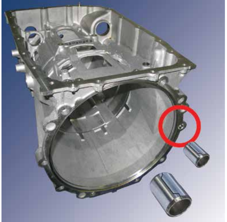
그라운드 할로우 다월은 엔진 뒤쪽의 정확한 자동차 변속장치 케이스 위치를 찾아냅니다.
