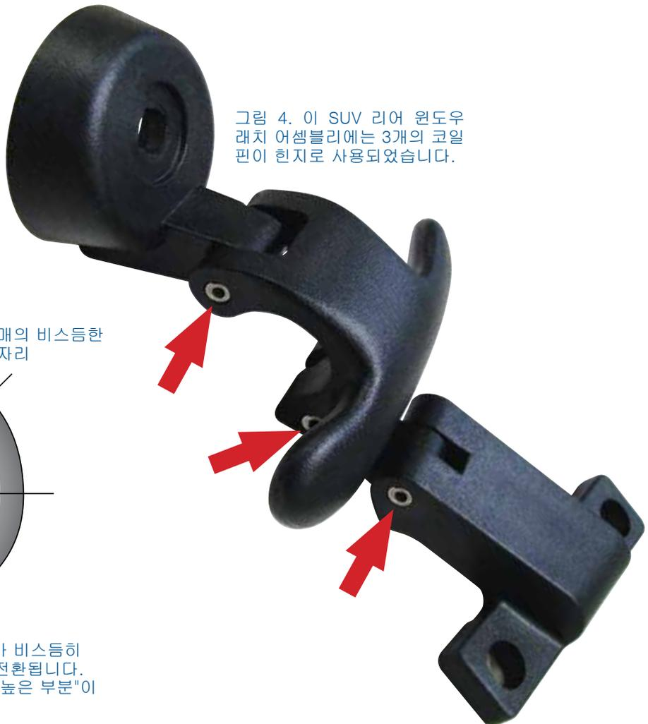
그림 4. 이 SUV 리어 윈도우 래치 어셈블리에는 3개의 코일 핀이 힌지로 사용되었습니다.
