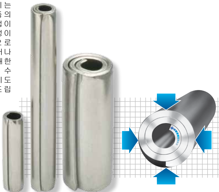
하중 작용 시 유연성: 코일 핀은 삽입 후 핀에 하중이 가해지는 경우에도 계속 해서 휘어집니다.
