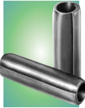
시리즈 550 화장품 케이스용 코일 핀을 사용하면 마찰력을 제공하기 위해 내부 구멍과 외부 구멍을 오정렬시킬 필요가 없으므로 설계가 간소화됩니다. 생산 환경에서 의도적인 오정렬은 제어하기가 어려우며 힌지 부분의 응력을 유발하여 균열과 핀 빠짐을 초래합니다. 다음은 화장품 케이스를 설계할 때 따라야 할 몇 가지 지침입니다.
