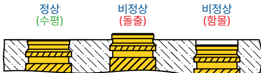
insert의 상단은 플라스틱의 표면과 최대한 수평으로 설치되어야 합니다.
