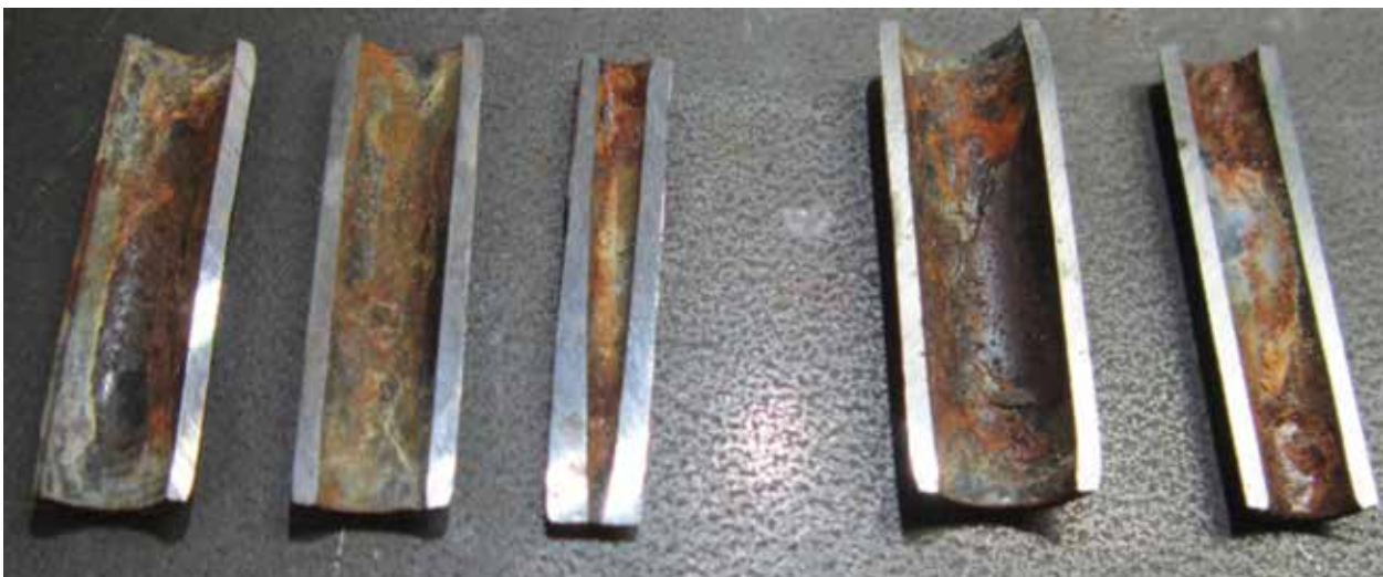
그림 4: 코일 핀의 강철 코일(또는 말린 부분) 사이의 부식을 보여주기 위해 그림 3에 나타난 핀의 단면을 자른 후 찍은 사진이 아래에 있습니다.
