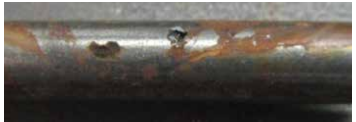
그림 7: 420 스테인리스강 슬릿 핀에 생긴 얼룩과 피팅.
