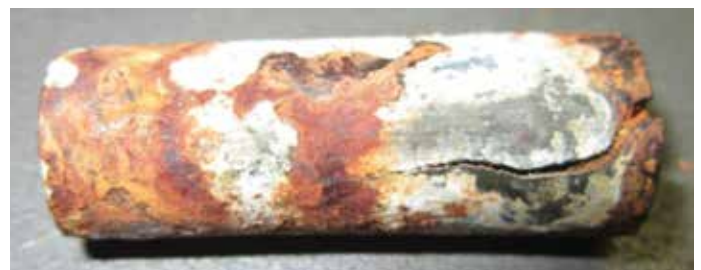
그림 2: 이 코일 핀은 저하중 아연 도금, 그리고 이후 크롬산염 디핑으로 마감 처리되었습니다. 마감 처리는 48시간 동안 '적색' 부식 보호를 제공하는 것으로 판정되었습니다. 이 부품을 200시간 동안 염수분무 시험했을 때 적색 녹이 심각하게 나타났지만 일부 아연과 흰색 부식이 남아 있었습니다. 표면에 아연이 남아 있는 부분에서는 인접 영역이 심하게 부식되어 있어도 적색 녹이 생기지 않았습니다.
