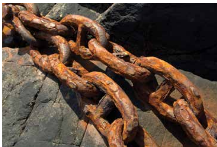
그림 1. 녹슨 체인은 녹 또는 전반적 부식 조건으로 인한 재료 손실을 보여줍니다.
