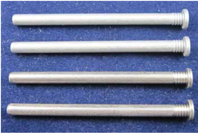
그림 5: 테스트 전의 핀: 위쪽 두 개는 아연 박층으로 코팅한 저탄소강이고 아래쪽 두 개는 오스테나이트 305 SST입니다.
