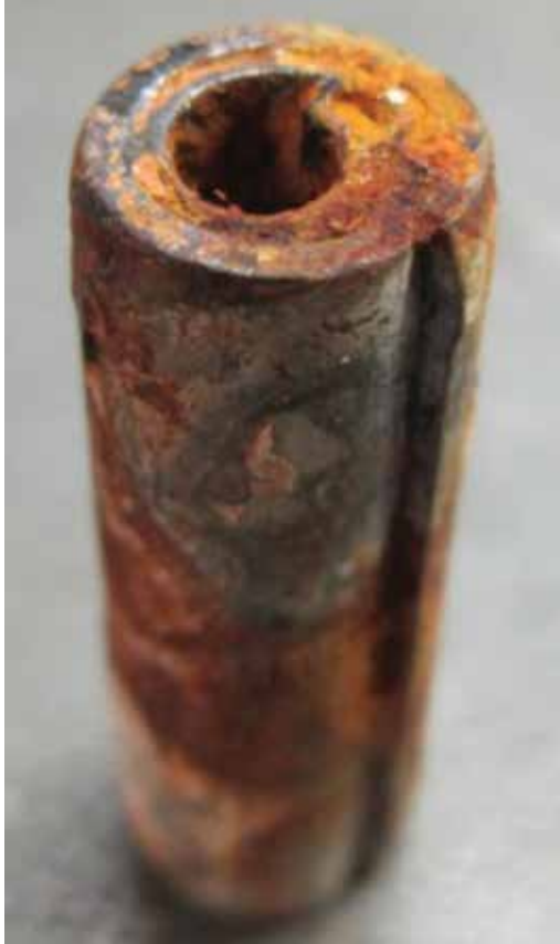
그림 3: 이 사진은 코일 핀의 기본적 형상(금속이 여러 겹으로 말린 형태)을 보여줍니다. 도금은 말린 부분 사이에 침투하지 못하며, 내부를 도포할 수 있는 딥 코팅도 핀의 말린 부분에는 효과를 보이지 않습니다.
