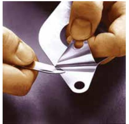
적층 심은 여러 겹의 정밀 금속 호일이나 복합재 필름을 합성 수지 접착제로 표면 결합시켜 시트로 만드는 방법으로 생산됩니다. 호일 재료로는 알루미늄, 스테인리스강, 탄소강 및 브라스가 주로 사용됩니다. 완성된 심의 두께는 0.006 ~ 0.250인치입니다. 열과 압력이 가해져 결합이 이루어지는데, 이 때 합성 수지는 거의 검출이 되지 않을 정도로 경화되고 줄어듭니다. 그러나 약 150°C(300°F) 이상의 온도에서는 결합제가 열화되고 전체 두께가 줄어들지만 무시할 수 있을 정도입니다. 그러나 합성 수지를 230°C(446°F) 이상까지 가열해도 심의 성능에는 영향을 미치지 않습니다.
